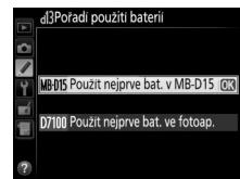
Používají-li se baterie v Battery Packu MB-D15, zobrazuje se na kontrolním panelu fotoaparátu symbol
