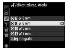
Při použití objektivu bez CPU je průměr této plošky fixován na 8 mm, bez ohledu na nastavení položky **Data objektivu bez CPU** v menu nastavení (□ 149). Je-li vybrána možnost **Integrální**, měří se při použití objektivů s vestavěným CPU integrálně celé obrazové pole.
