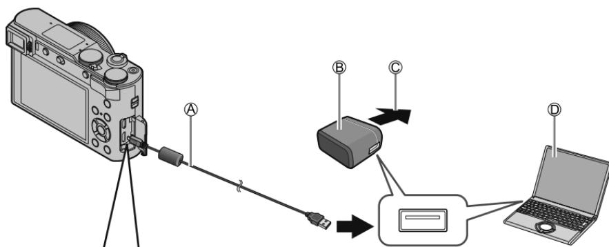
**Při nabíjení fotoaparátu, připojte USB kabel (dodávané příslušenství) ke konektoru [USB/CHARGE]**
