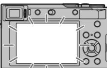
\* Pokud je položka [Eye Sensor AF] (Automatické zaostřování s aktivním snímačem přiblížení oka) v menu uživatelských nastavení [Custom] nastavená na možnost [ON] (Zap.), fotoaparát bude po aktivaci snímače přiblížení oka automaticky nastavovat zaostření. Z fotoaparátu nezazní zvuková signalizace, pokud se zaostření dosáhne pomocí [Eye Sensor AF] (Automatické zaostřování s aktivním snímačem přiblížení oka).
