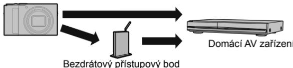
**MENU** → **Menu nastavení [Setup]** → **[Wi-Fi]** → **[Wi-Fi Function] (Funkce Wi-Fi)** → **[New Connection] (Nové připojení)** → **[Send Images While Recording] (Odesílání snímků během snímání)/[Send Images Stored in the Camera] (Odesílání snímků uložených ve fotoaparátu)** → **[AV device] (AV zařízení)**
